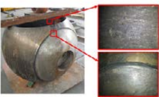
شکل ۳- پدیدارشدن حفرات در زیر پوشش الکترولس نیکل □ فسفر بعد از عملیات آب برداری
